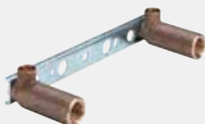
Gemini-Montažna plošča - spajkalni priključki, Rp-navoji - enostransko dolg Oprema Kotni fitting rdeča litina dolg (se lahko krajša), držalo (plosko) iz pocinkanega jekla Model 94476
