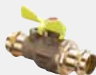
Profipress G-Plinska kroglična pipa s SC-Contur - zatisni priključki - za zaklepanje Oprema Ohišje rdeča litina, sprožilni ročaj iz jeklene pločevine z rumenim prašnim premazom, odprtina za preizkušanje, tesnilni elementi HNBR Tehnični podatki HTB (za višjo temperaturno obstojnost) 650 °C/30 min C1 delovni tlak max. 0,5 MPa (MOP 5) z oznako o opravljenem preizkusu po DIN DVGW-G Model 2671
